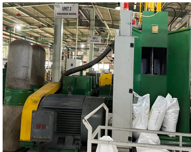
Thiết bị thu hồi bụi tại máy trộn nạp liệu Roller mixing compound
