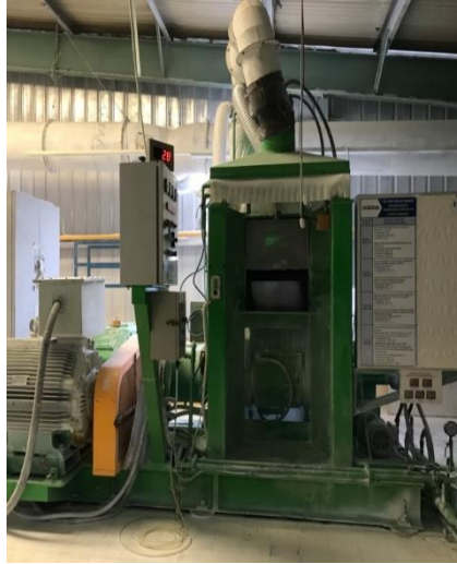
Hệ thống thu gom bụi tại công đoạn nạp liệu, tiếp liệu tại máy trộn (Kneader mixing)
