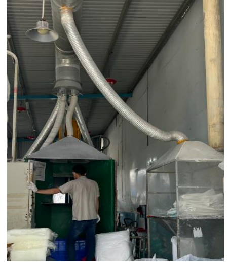
Hệ thống thu gom bụi tại công đoạn nạp liệu, tiếp liệu tại máy trộn (Kneader mixing)
